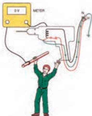
شکل ۴-۲۶ دستگاه دریل دارای سیم ارت
