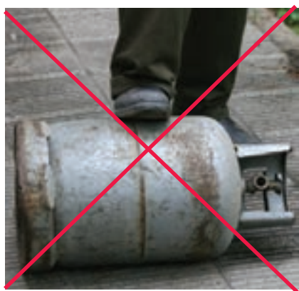
شکل ۶۹-۱ حمل و نقل نادرست کپسول گاز مایع
